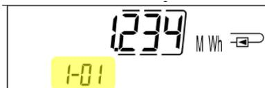
Durch **einmaliges, kurzes Drücken** der Bedientaste wird der Gesamtverbrauch seit Inbetriebnahme des Zählers angezeigt (Anzeigeschleife **1-01**).
