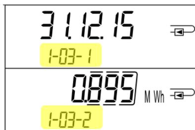
Nach Anzeige des Gesamtverbrauchs (Punkt 1) Taste **weitere zwei Mal kurz** betätigen (bis Anzeigeschleife 1-03-1). Innerhalb einer Wechselanzeige werden nun zuerst das Datum des letzten Stichtags (**1-03-1**) sowie der Gesamtverbrauch am Stichtag (**1-03-2**) angezeigt. Wurde der Stichtag noch nicht durchlaufen, wird 00.00.0000 angezeigt.
